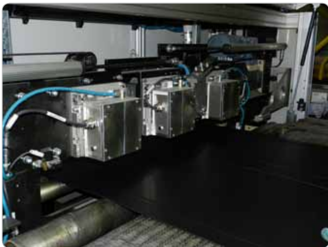
Obr. 1 Merací systém hrúbky gumeného pásu pozostávajúci so šiestich optických snímačov
