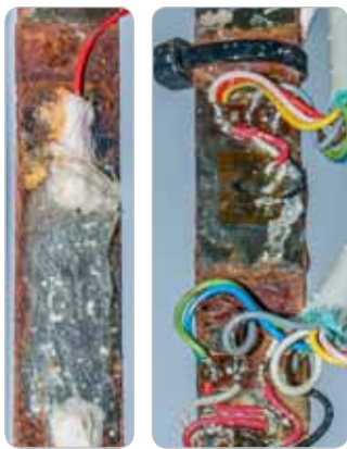
Obr. 1 FBG optické vlákno priamo lepené na meraný povrch (UV lepenie) – stav po dvoch mesiacoch v koróznom prostredí Obr. 2 Odporové snímače deformácie (krytie – polyuretánový lak) – stav po dvoch mesiacoch v koróznom prostredí
