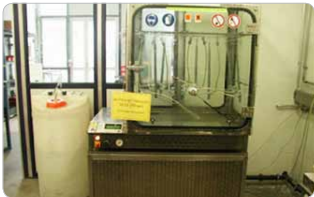
Obr. 1 Komora so siričitou atmosférou vo firme DEHN + SÖHNE
