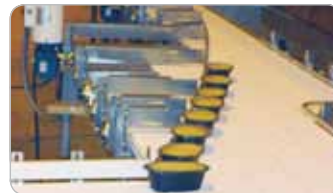
Obr. 9 Vďaka nízkemu protitlaku sa beztlakový zlučovač často používa na prepravu sklenených fliaš, aby nedochádzalo k ich rozbitiu.
