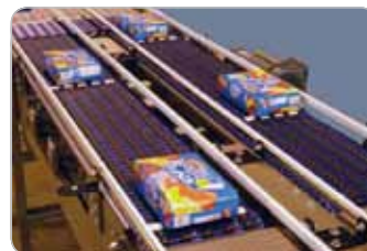
Obr. 8 Merací/usmerňovací dopravník dokáže prepravovať zabalené hotové výrobky.
