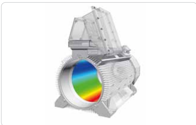
Obr. 1 Modelovanie rotačných elektromagnetických síl pri výpočte vibrácií
